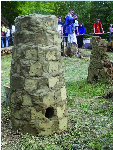
Ryc. 1.3. Współczesna rekonstrukcja dymarki, źródło: Internet, Wikipedia
